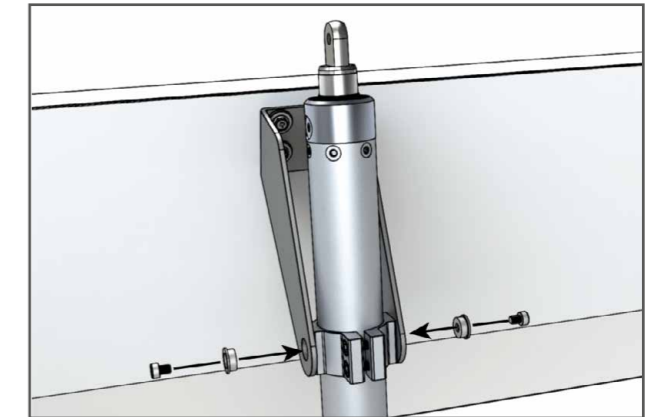
24 V Motor mit 2x M5x6 und 2x Lagerbolzen in werkseitig vormontierte Motorhalterung einbauen.
