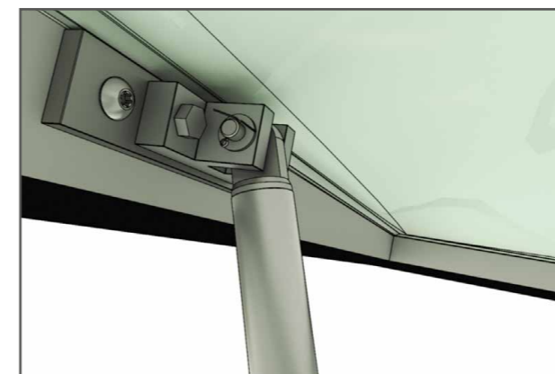
Flügelbockbolzen, Augenschraube und Flügelbock verbinden. Flügelbockbolzen durch Splint sichern.
