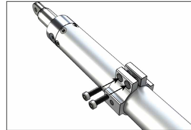
Klemmring mit 2x M5x16 an Motorgehäuse fixieren.
