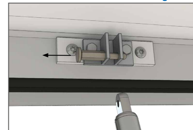
Zum Öffnen des Dachausstiegs den Flügel von der Lüftungseinheit entkoppeln. Hierfür den Federbolzen zurückziehen.
