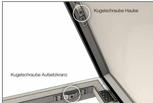
Die Positionen der werkseitig vormontierten Kugelschrauben beachten.
